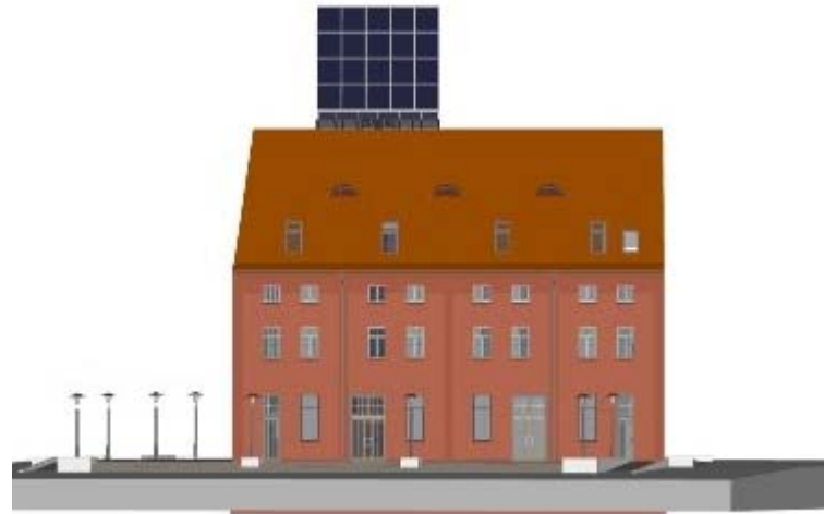
Wiederherstellung und Ergänzung ursprünglicher Fensterformate
